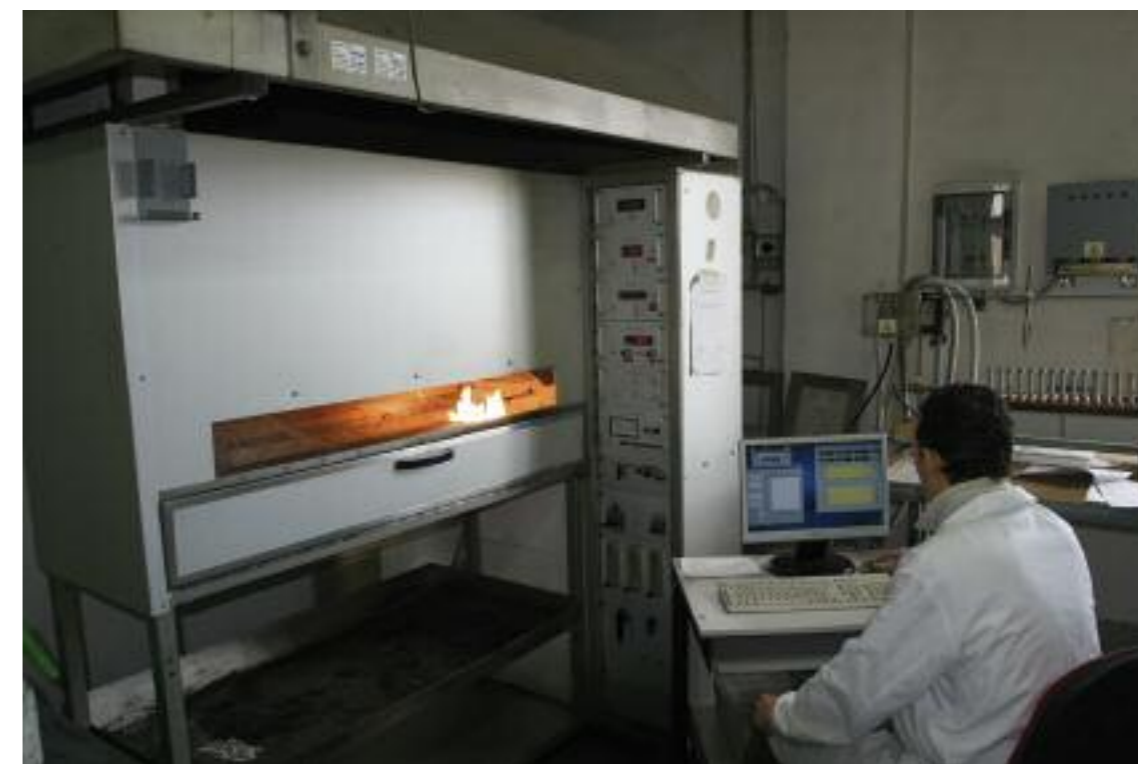
Foto 5 - Apparecchiatura per il metodo "Pannello radiante rivestimento pavimento (EN ISO 9239-1) - Prova in corso
