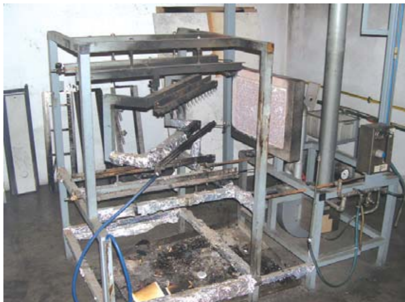
Foto 2 - Pannello radiante (UNI 9174)
