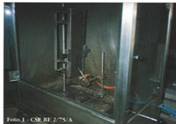
Nelle immagini: la prova alla piccola fiamma CSE RF 2/75/A suscettibile di prendere fuoco su una sola faccia, la prova al pannello radiante CSE RF 3/77 e l'apparecchiatura per il Radiant Panel Test.
