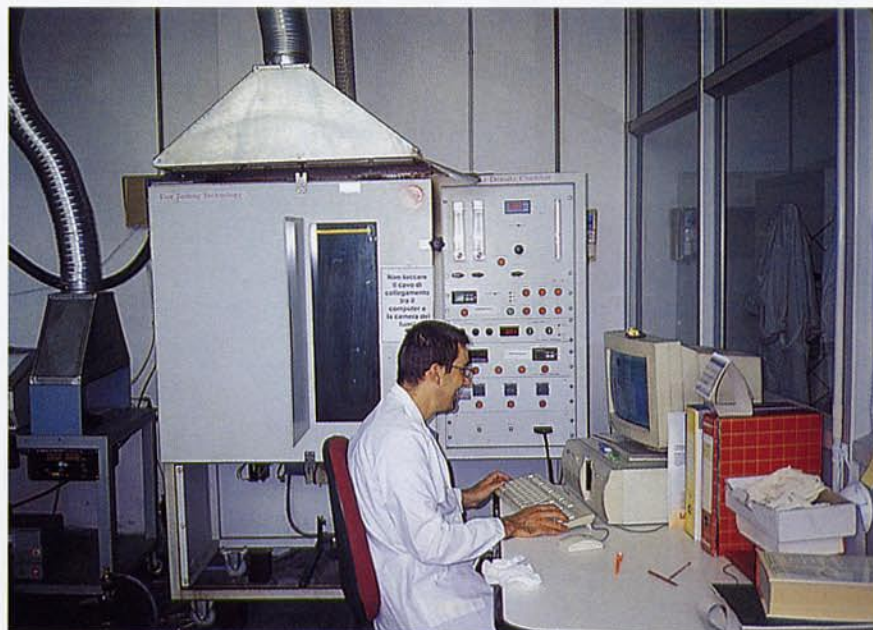
CAMERA FUMI FERROVIARIO. CONO CALORIMETRO VIC 564.2. IN BASSO: TOUCH TEST AERONAUTICO
