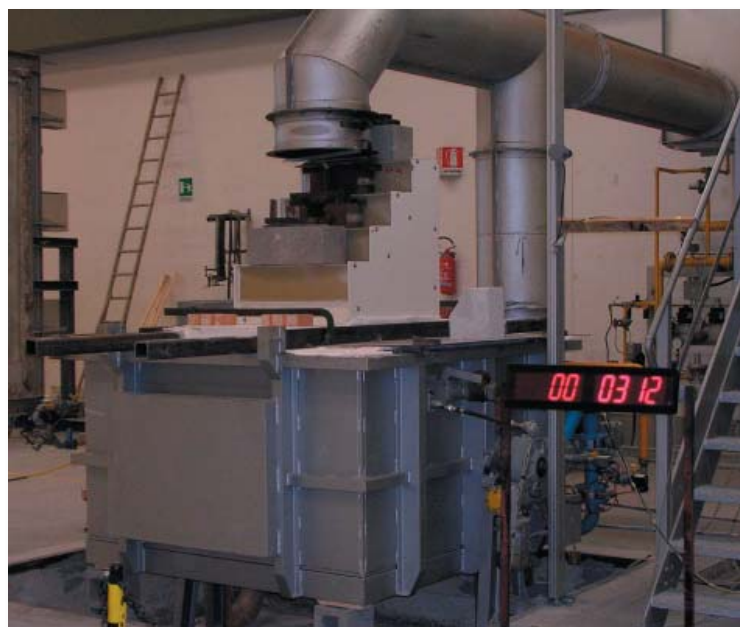
Scala di piano Test resistenza al fuoco
