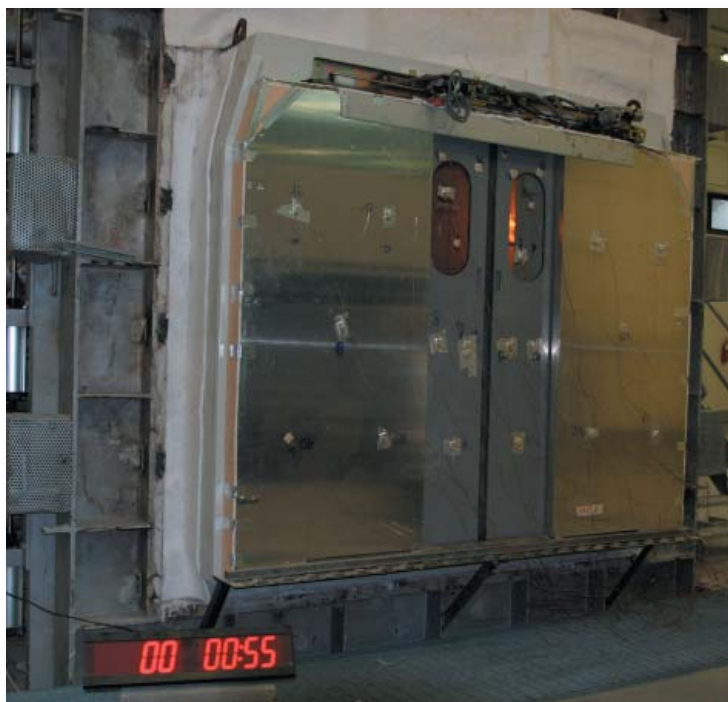
Parete di Testa Test resistenza al fuoco EN 1634-1
