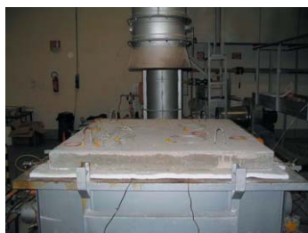
Figura 3: posizionamento del campione sulla bocca del forno
