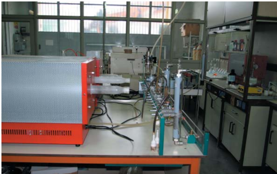
Forni tubolari per AFNOR NF X 70 -100 Tossicità dei gas di combustione
