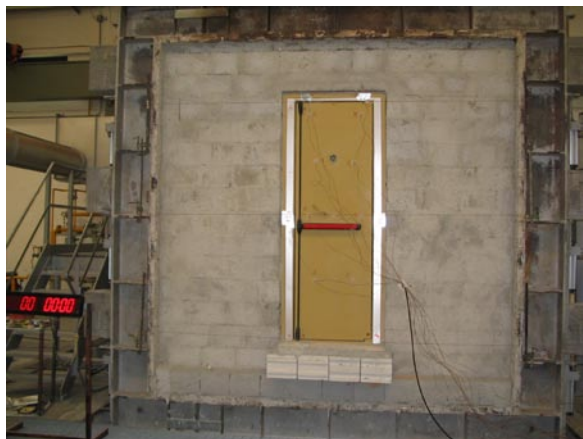
Porta cabina di guida - Test resistenza al fuoco EN 1634-1
