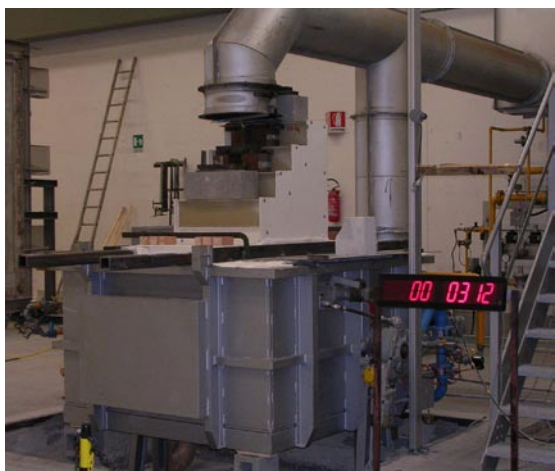
Porta cabina di guida - Test resistenza al fuoco EN 1634-1
