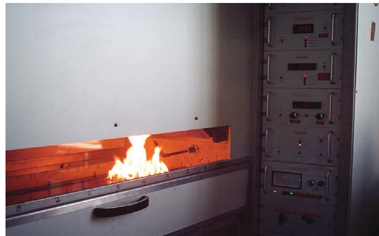
Foto 2- EN ISO 9239-1 - Pannello radiante per pavimenti
